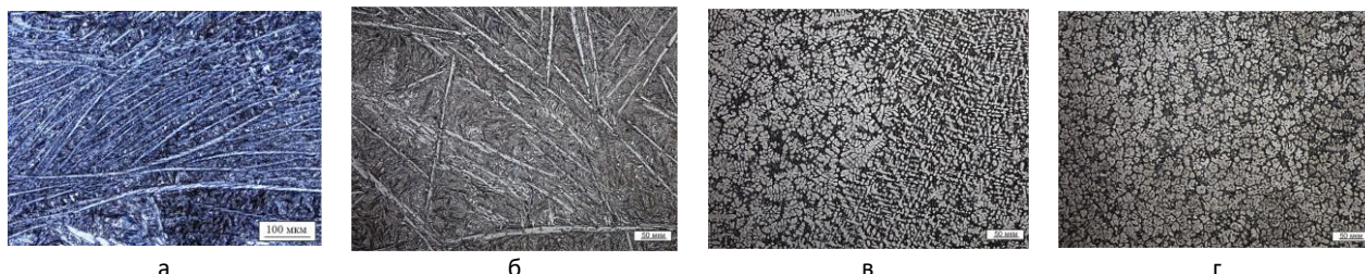
Рис.1. Микроструктура сформированных модифицированных слоев: а – 30 секунд; б – 2 минуты; в – 5 минут; г – 10 минут
