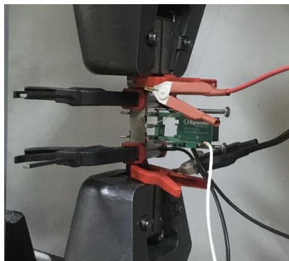
Рис. 1. Образец в захватах испытательной машины
