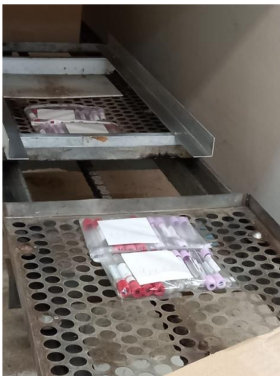
Рис. 1. Размещение облучаемых образцов пробирок на конвейер
